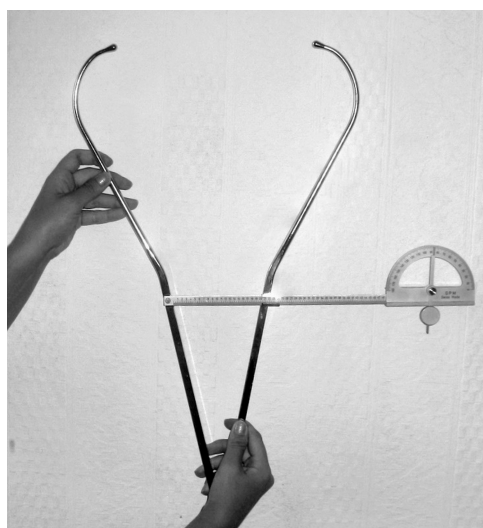
Рис.1. Скользящий циркуль и большой толстотный циркуль с прикрепленными гониометрами
